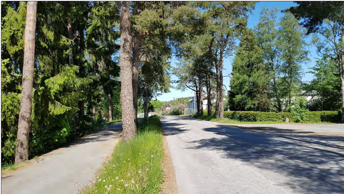
Kuva 10. Osa puista ovat kiinni tienlaidassa. Näitä puita on varsin haasteellista suojata ja vaativat erityishuomiota teiden päällystetöiden aikana.
