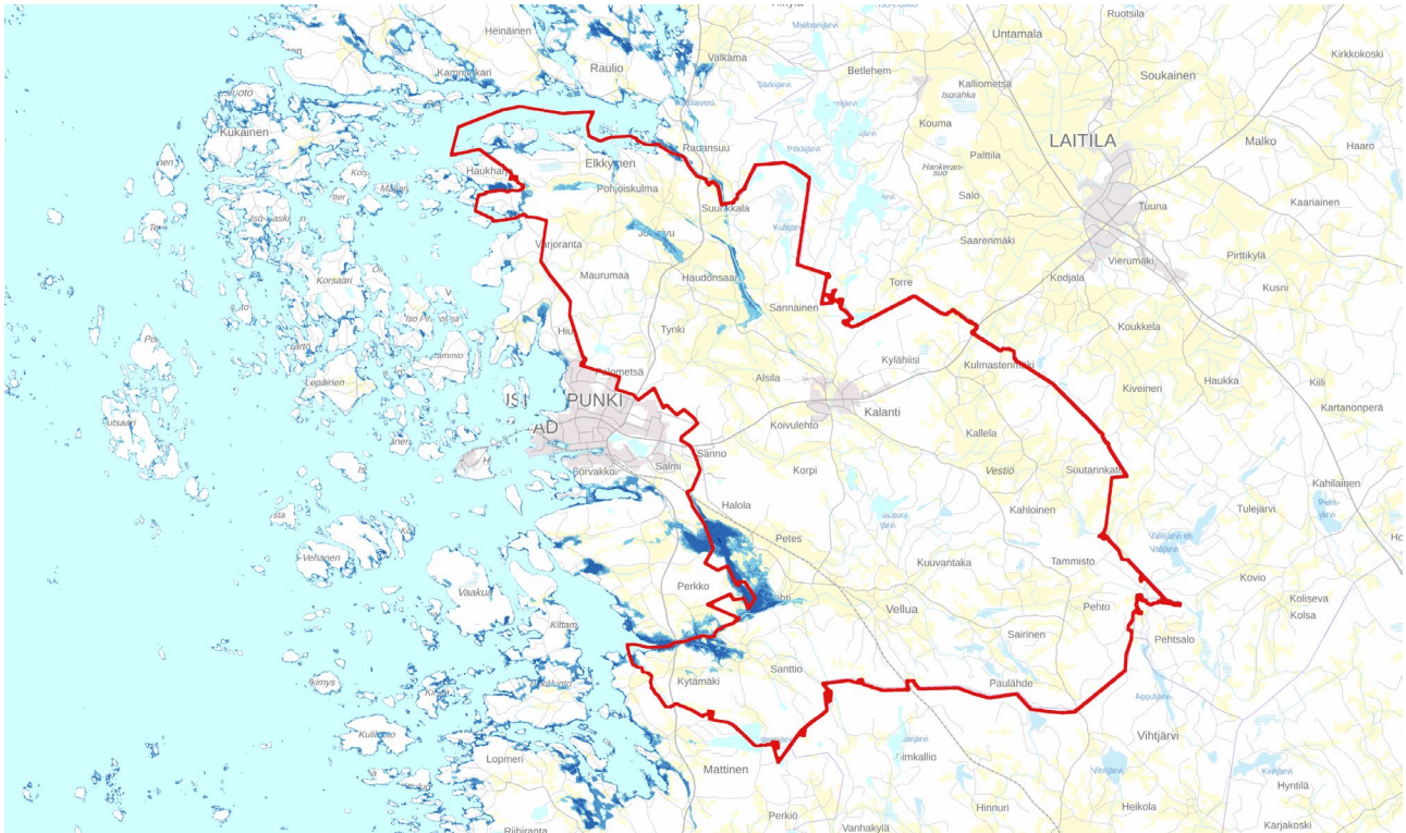
Kartta 4 Suunnittelualueen tulvariskialueet. Tulvan riski ja syvyys ovat suurempia mitä tummempi sininen kartassa on esitetty. Suunnittelualue punaisella. Lähde: SYKE.
